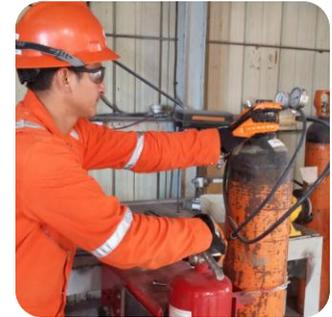
Durante el mantenimiento se identifica si algún extintor requiere prueba hidrostática y de ser así se le aplica.
